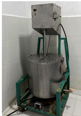
Gambar 2. Mesin Pasteurisasi i-SuKa
