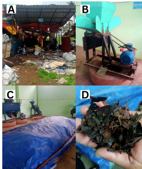
Gambar 1. Proses pengomposan di TPA Talangagung Malang (Dokumentasi Pribadi). (A) Pengumpulan dan pemilahan sampah organik, (B) Mesin Crasser (mesin pencacah organik), (C) Pengomposan, (D) Kompos.
