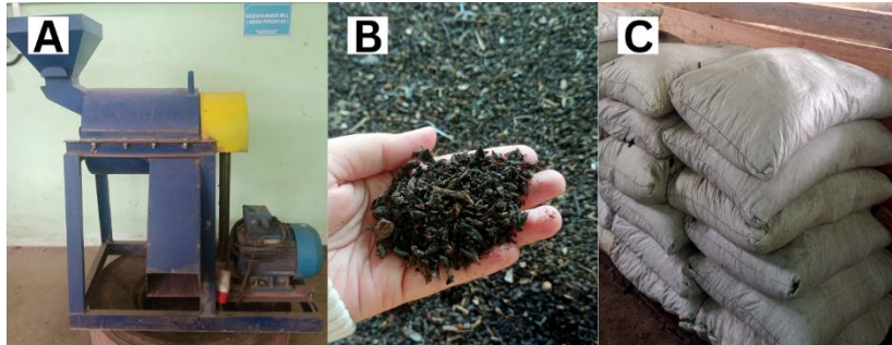
Gambar 2. Hasil pengomposan dari sampah organik di TPA Talangagung Malang (Dokumentasi Pribadi). (A) Mesin Hummer Mill (mesin pengayak), (B) Kompos hasil ayakan, (C) Pengemasan kompos
