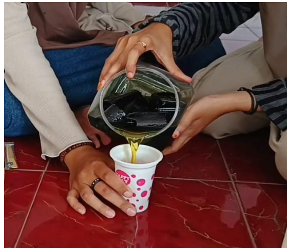
Gambar 1. Proses penyaringan minyak jelantah yang sudah direndam dengan arang selama 24 jam
